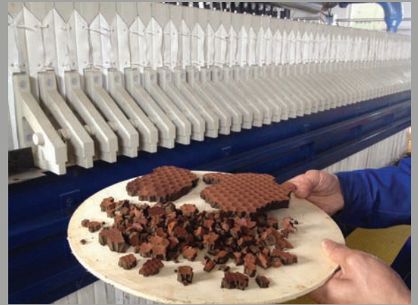
Filterpresse für Kuchentrocknung mit Membranplatten bis 2500 x 2500 mm
