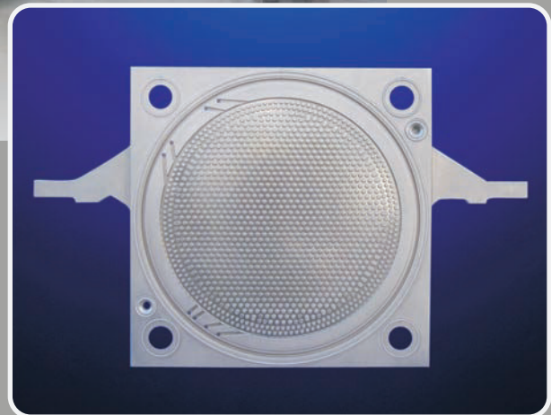
630 x 630 mm mit ECKEINLAUF und eingeschweisster PP-Membran
