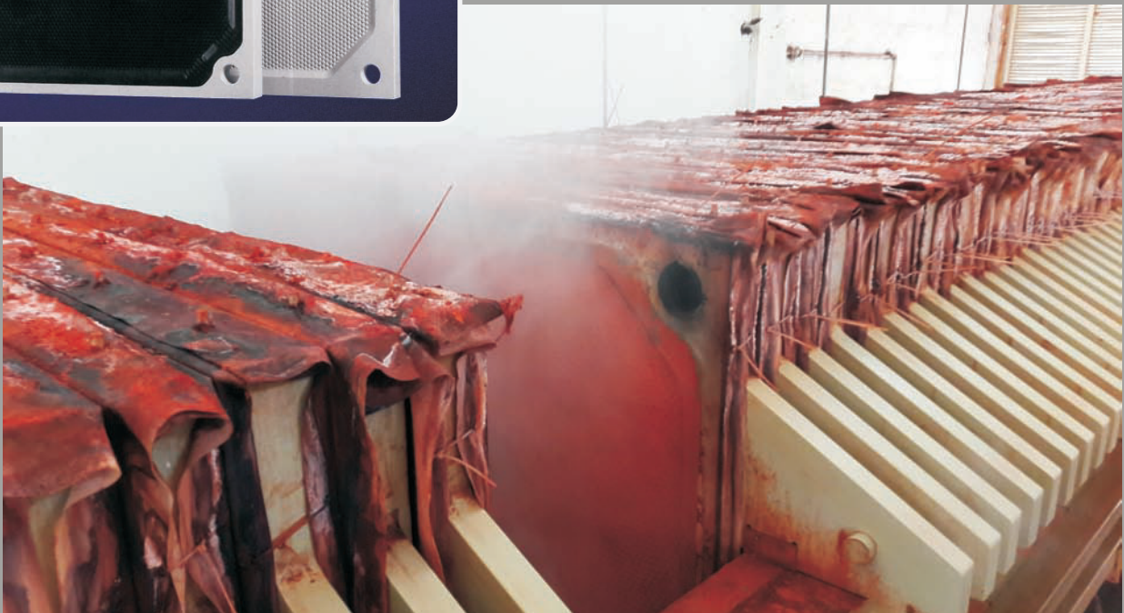
1500 x 1500 mm, Zentraleinlauf, interne Ausläufe
