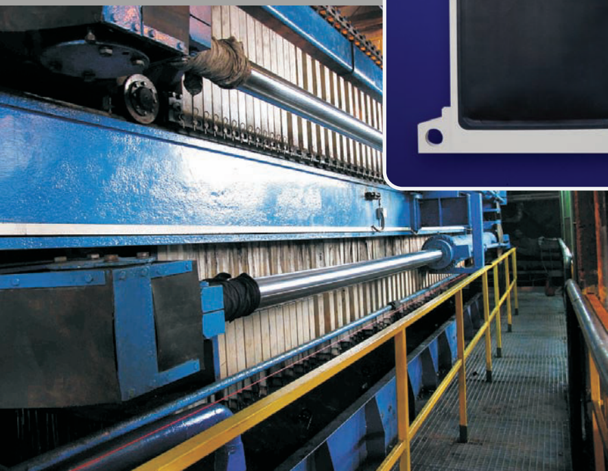
3200 x 2800 mm, externer Einlauf, externe Filtratausläufe
